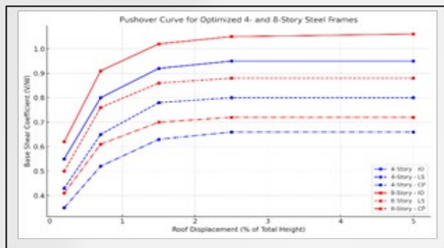
شکل ۶. نمودار نیرو-جابجایی (Pushover Curve) برای قاب‌ها
